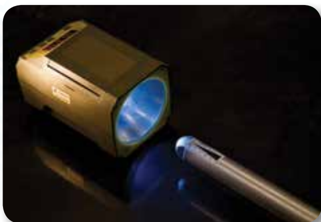
频闪观测仪测量振动棒棒头的振动频率与转速
