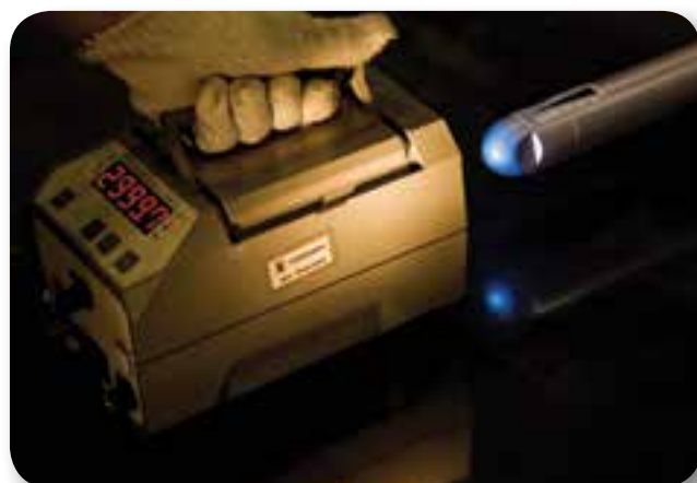
频闪观测仪测量振动棒棒头的振动频率与转速
